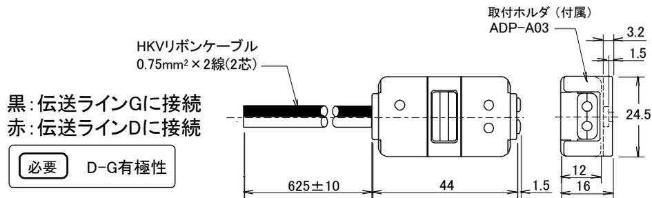
取付ホルダ (ADP-A03) による取付穴加工寸法
