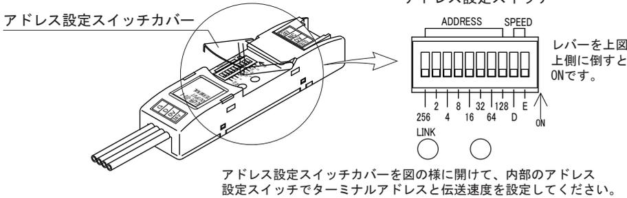
アドレス設定スイッチカバーを図の様に開けて、内部のアドレス設定スイッチでターミナルアドレスと伝送速度を設定してください。
