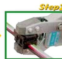
専用工具でクランプして圧接
