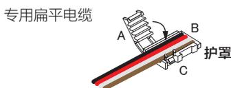
装有护罩状态。确认挂钩①、②处于嵌合状态。
