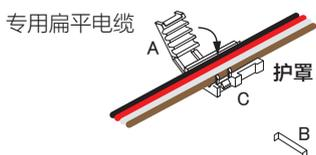
装有护罩状态。确认挂钩①、②处于嵌合状态。
