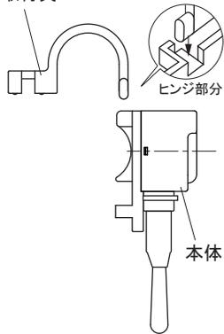
取付具Bをパイプに掛け、本体を引き寄せて合体させます。本体爪が取付具Bの溝に挟まると、仮固定状態となります。
