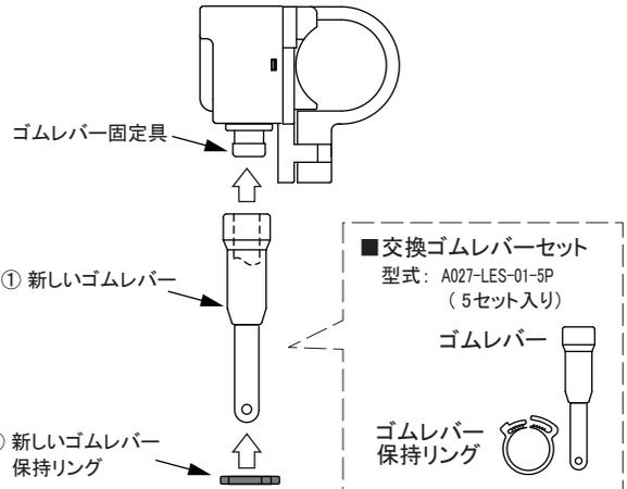
(2) ゴムレバー保持リングを正面図の(D)位置(ゴムレバー根元)に装着します。
